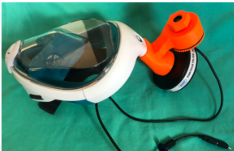
Umístění kamery na masku "Decathlon" s adaptérem pro P3R filtr
